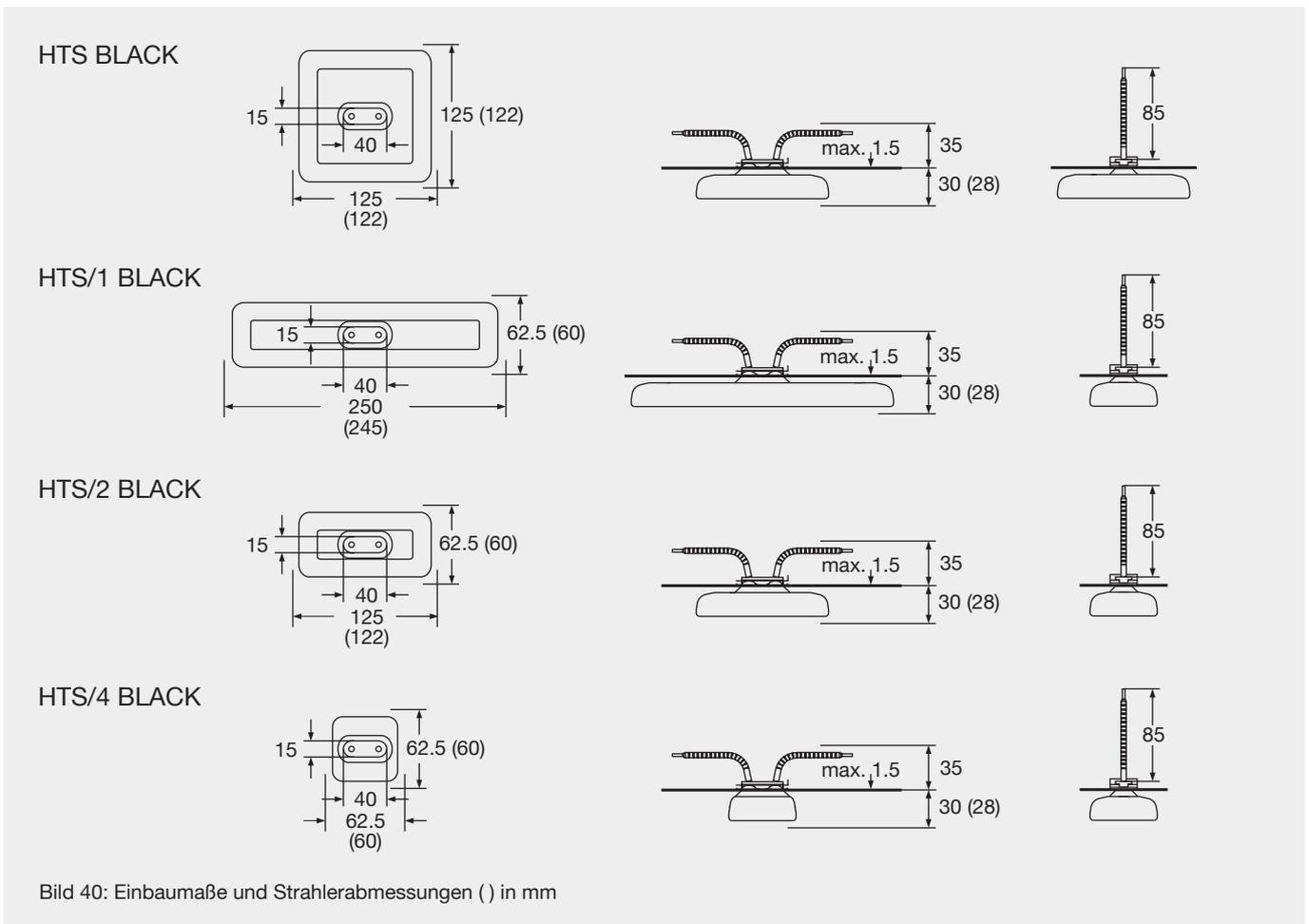
Bild 40: Einbaumaße und Strahlerabmessungen ( ) in mm
