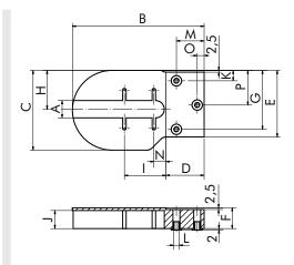
Fig.: Right bracket (C) PE
