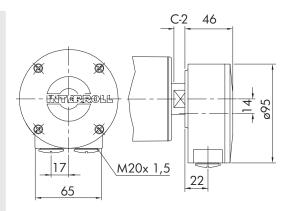
Fig.: Terminal box, aluminum
