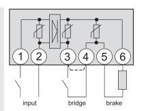
Fig.: Bridge rectifier
