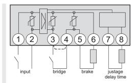
Fig.: Fast-acting rectifier
