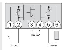
Fig.: Phase rectifier
