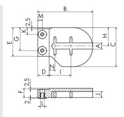
Fig.: Left bracket (B) PE
