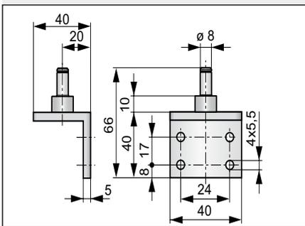
**Befestigungsbeschlag Bestell-Nr. 205262, aus V2A: 205282, aus V4A: 205456**
