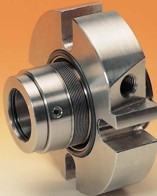
Patronendichtung mit Metall-lamellenbalg-Gleitringdichtung, entlastet, drehrichtungsunabhängig
