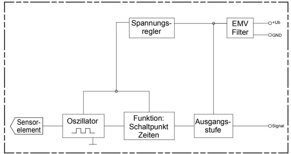
**Funktionsdiagramm für MINIMUM Sonden**
