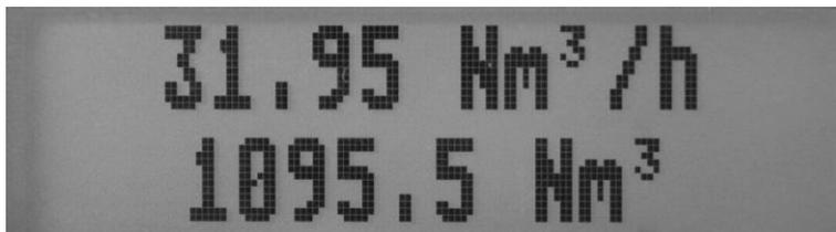
Zeile 1: Aktueller Momentanwert - Volumstrom/Massenstrom/Strömungsgeschwindigkeit
